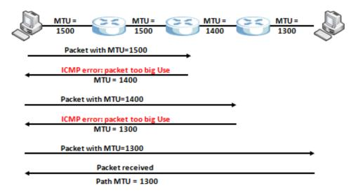
Figure 錯誤!所指定的樣式的文字不存在文件中。-5: A Scenario of Path MTU Discovery Mechanism.
